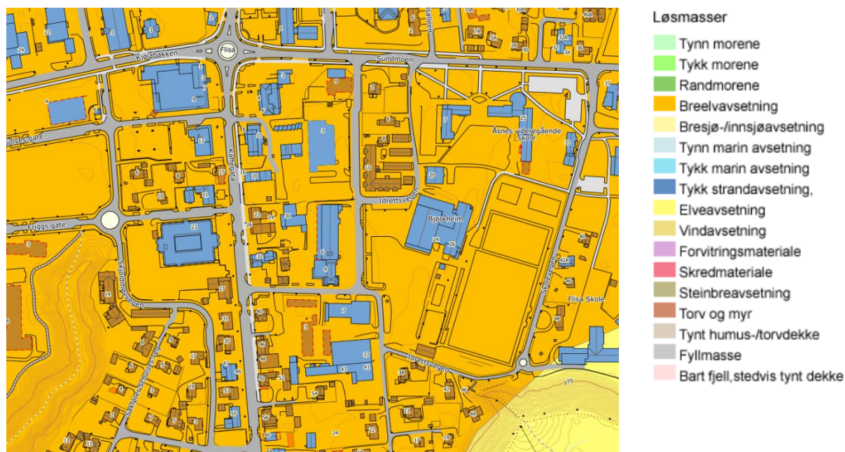
Figur 8 - Løsmassene på planområdet utgjøres av breelvavsetninger.
